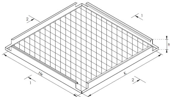
Общий вид панели MESH HOOK-ON 200
